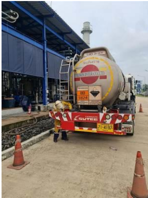
ภาพที่ 2-28 การติดตั้งเครื่องหมาย ป้ายวัตถุอันตราย และเบอร์โทรศัพท์ที่ตัวถังของรถบรรทุกสารเคมี
