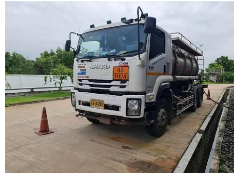
ภาพที่ 2-28 การติดตั้งเครื่องหมาย ป้ายวัตถุอันตราย และเบอร์โทรศัพท์ที่ตัวถังของรถบรรทุกสารเคมี
